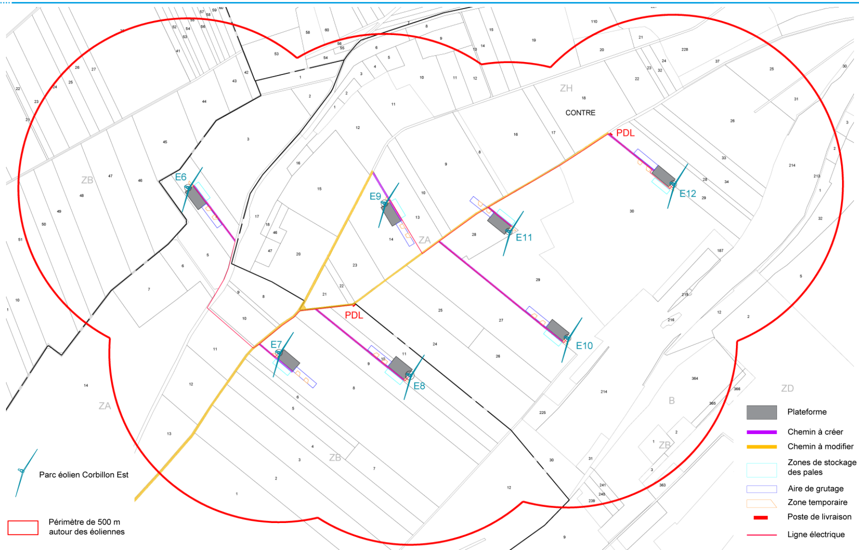
Carte 5 : Chemin à créer et à modifier pour le parc éolien de Corbillon-Est – Source : Ventelys Energies Partagées
